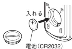
3 電池フタを強く押しながらかし、最後まで閉めます。
