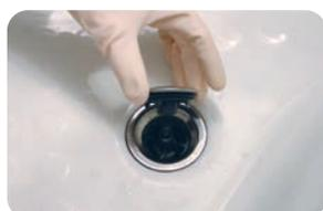
④元へ戻すときは、排水ボタンを押して“閉”状態にし、フタの裏側にある穴を排水ジョイントの軸に合わせ、パチンと音がするまで押し込みます。
