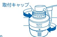
③ 上部ケースを反時計回りにまわして外し、浄水カートリッジを取り出す。
