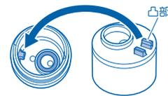
⑤ 浄水カートリッジ底面の凸部を下部ケース内部底面の凹部にあわせ、新しい浄水カートリッジを入れる。
