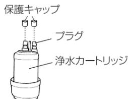
新しい浄水カートリッジの上端プラグに付いている保護キャップを取り外してください。（2ヶ）
