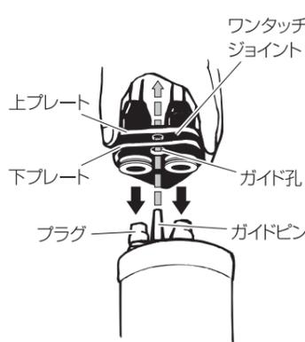
ワンタッチジョイントのプレートにあるガイド孔と浄水カートリッジのガイドピン及びプラグに合わせて垂直に「カチッ」と音がするまでしっかり押し込んでください。
