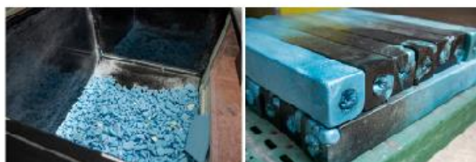
スチロールポスト:浴室生産課でのスタイロフォームのリサイクル化
